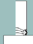
c)-1 橋脚の曲げ破壊
